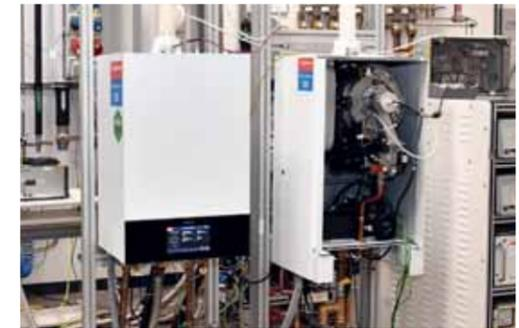
Zwei Prototypen zu 100 % H<sub>2</sub>-ready auf dem Prüfstand: Nach der Erprobung folgen die Qualifizierung, Dauererprobung und schließlich ihr Einsatz in realen Heizungsanlagen.
